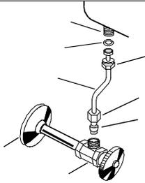
Conecte la tubería de agua fría al tanque con su dispositivo de retención recto o en ángulo. Coloque la arandela, luego la tuerca plástica en el extremo del tanque del tubo de conexión y doble el tubo para encaje en el agujero de entrada del regulador de agua. Apriete todas las tuercas de acople de forma segura. **¡NO UTILICE MASILLA DE PLOMERO!**
