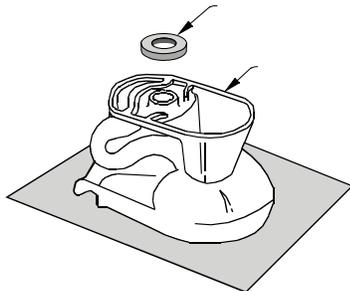
Nettoyer soigneusement le plancher environnant. Insérer les boulons du nouveau WC dans la bride rainurée, têtes des boulons tournées vers le bas. La cuvette doit être renversée sur une surface douce pour éviter les éraflures. Placer l'anneau en cire légèrement chauffé dans le creux circulaire dans le socle de la cuvette.
