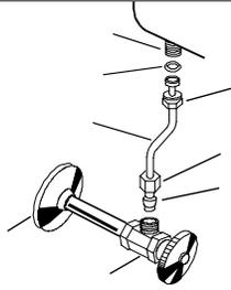
Brancher la conduite d'eau froide au réservoir avec l'arrêt droit ou d'équerre. Placer la rondelle puis l'écrou en plastique sur l'extrémité réservoir du tuyau de raccord et plier le tuyau pour aller dans le trou d'alimentation sur le régulateur d'eau. Bien serrer tous les écrous de serrage.
