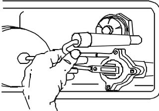
Brancher le tuyau en plastique du dessus du régulateur d'arrivée d'eau dans son anneau de maintien à l'intérieur du tuyau de trop-plein. Si nécessaire, on peut couper l'excédent pour éliminer tout tortillement du tuyau.
