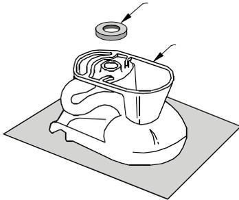
Limpie a fondo el área inmediata del piso. Coloque los nuevos pernos del inodoro en la brida ranurada, con las cabezas de los pernos hacia abajo. La taza del inodoro deberá colocarse en posición invertida, sobre material suave para evitar que se raye. Coloque el anillo de cera ligeramente calentado en la cavidad circular en la base de la taza
