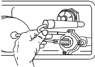
Conecte la tubería plástica de la parte superior del regulador de la entrada del agua en su aro retenedor dentro del tubo rebosadero. Si fuese necesario, el excedente puede recortarse para eliminar cualquier deformación de la tubería.
